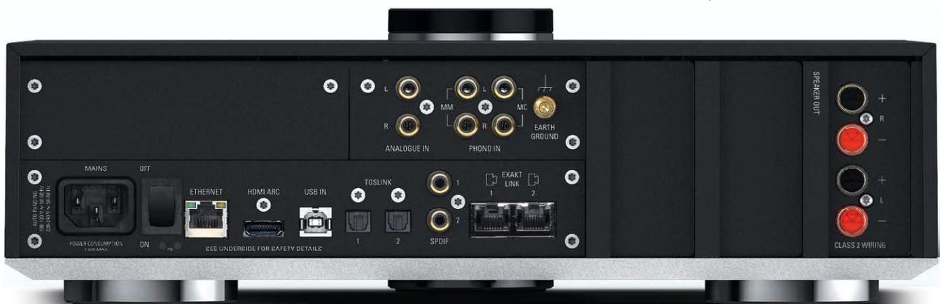
**MAN ACHE AUF DIE FREIEN FLÄCHEN:** Über Streckplätze lässt sich der Selekt DSM umfassend erweitern. Ganz rechts: das Endstufenmodul mit seinen Lautsprecherklemmen. Hinzu kommen so|| beispielsweise aber auch ein potenter Kopfhörer-Anschluss.
